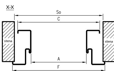
S0 - šírka montážneho otvoru
