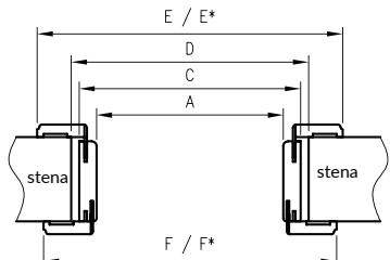
D - požadovaná šírka otvoru v stene
